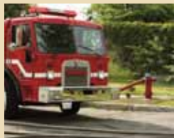
Abastecimento do hidrante de incêndio
